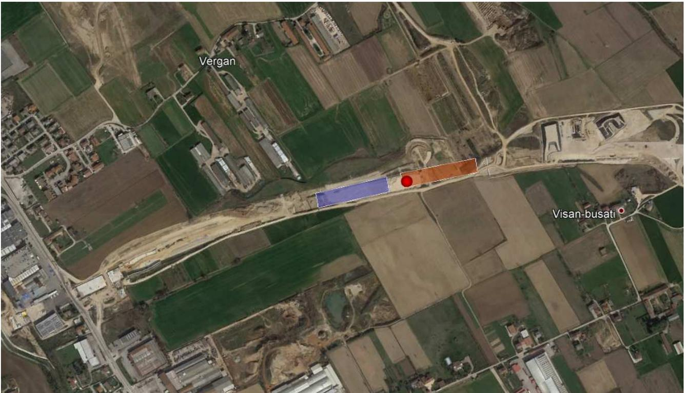
Figura 2. Individuazione area sito di messa in riserva (in colore azzurro – approvazione progetto con determinazione 780 del 20/07/2018 dalla Provincia di Vicenza) e dell'area nella quale sarà ubicato l'impianto mobile (in colore arancione – il pallino rosso rappresenta il punto dove sarà inizialmente ubicato l'impianto).
