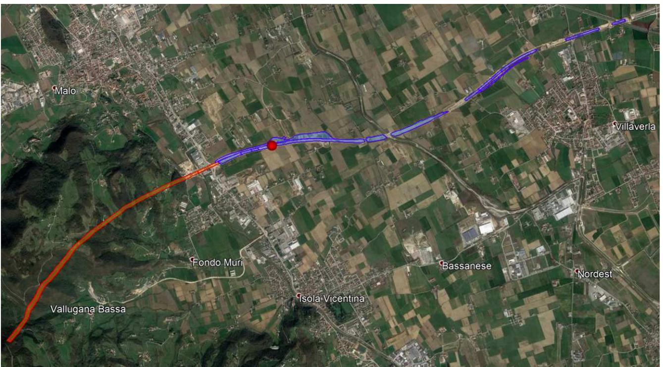
Figura 3. Individuazione delle aree del cantiere SPV dove sarà reimpiegato il rifiuto a seguito del processo di recupero (cfr. Tabella 1). In colore arancione sono evidenziati i tratti di infrastruttura in galleria artificiale/naturale. In questi ambiti l'attività di recupero non comporta alcuna interferenza con le matrici ambientali.
