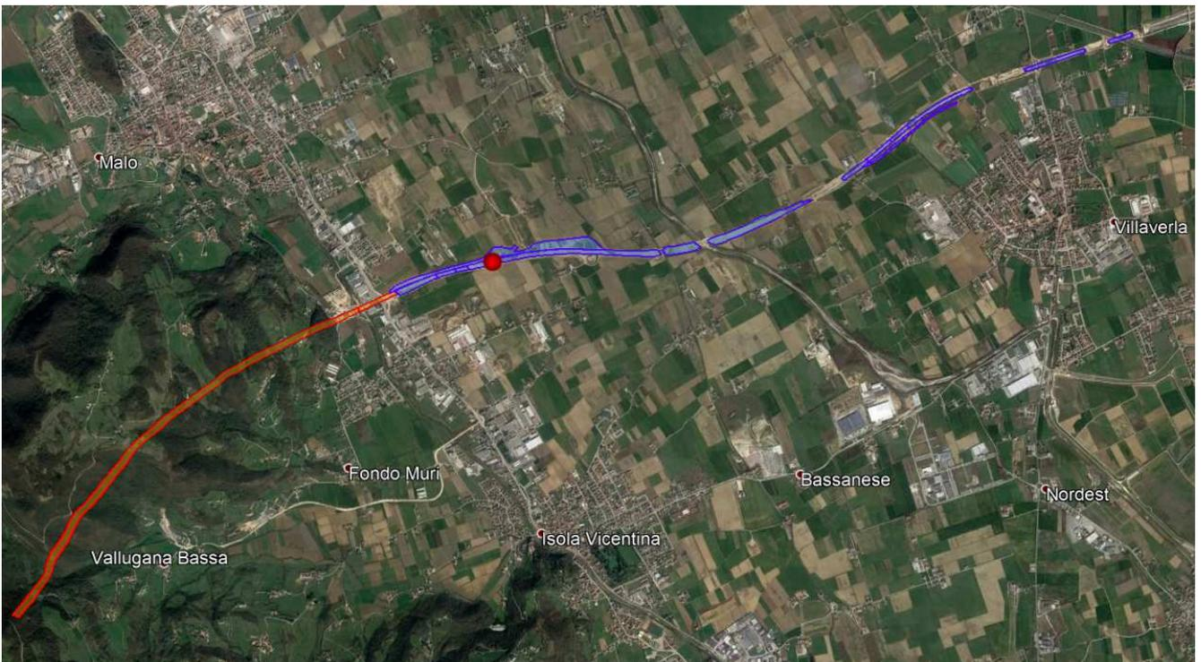
**Figura 16. Individuazione delle aree del cantiere SPV dove sarà reimpiegato il rifiuto a seguito del processo di recupero (cfr. Tabella 5). In colore arancione sono evidenziati i tratti di infrastruttura in galleria artificiale/naturale. In questi ambiti l'attività di recupero non comporta alcuna interferenza con le matrici ambientali.**
