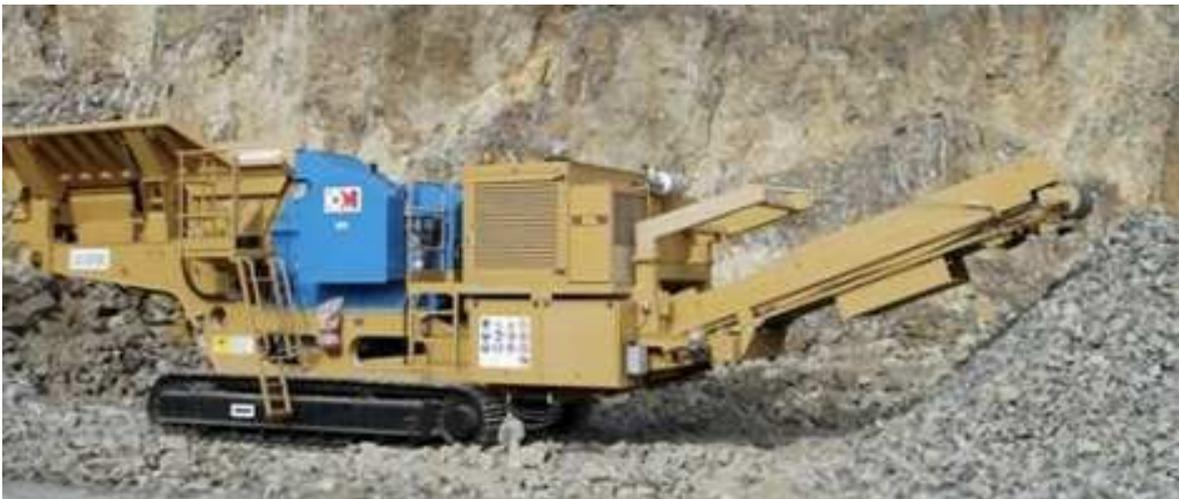
**Figura 17: Frantoio semovente a mascelle OM CRUSHER ULISSE**
