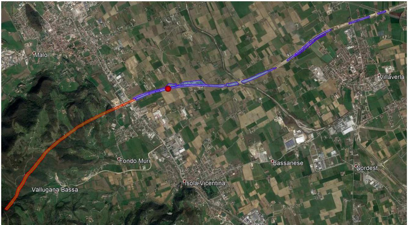
**Figura 2. Individuazione delle aree del cantiere SPV dove sarà reimpiegato il rifiuto a seguito del processo di recupero. il pallino rosso rappresenta il punto dove sarà inizialmente ubicato l'impianto. In colore arancione sono evidenziati i tratti di infrastruttura in galleria artificiale/naturale. In questi ambiti l'attività di recupero non comporta alcuna interferenza con le matrici ambientali.**
