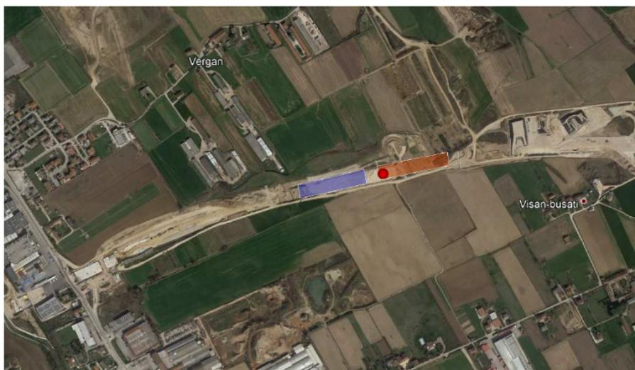
Figura 15. Individuazione area sito di messa in riserva (in colore azzurro – approvazione progetto con determinazione 780 del 20/07/2018 dalla Provincia di Vicenza) e dell'area nella quale sarà ubicato l'impianto mobile (in colore arancione – il pallino rosso rappresenta il punto dove sarà inizialmente ubicato l'impianto).
