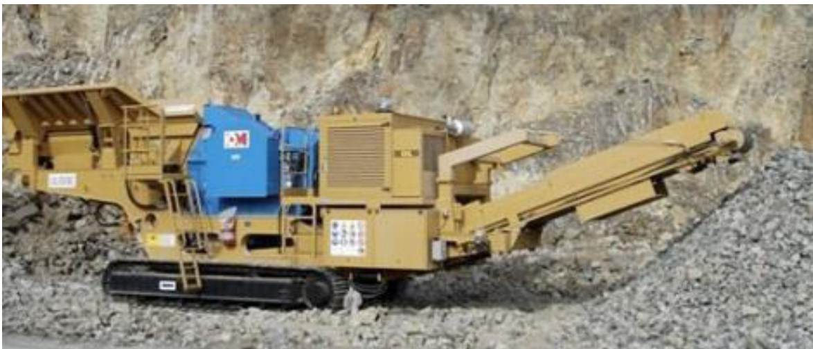
Figura 27. Frantoio semovente a mascelle OM CRUSHER ULISSE
