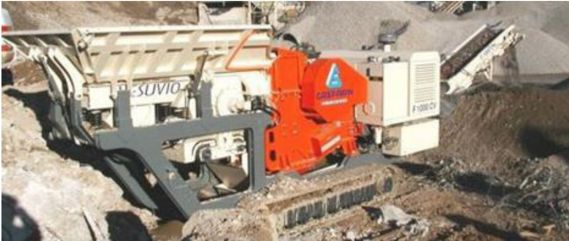
Figura 26. Frantoio semovente a mascelle VESUVIO SUPER F1000 CV
