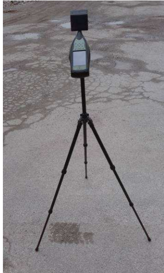
Foto n. 12 e n.13 : fase di calibrazione ad inizio e fine delle misure
