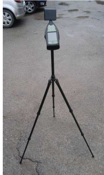
Foto n. 12 e n.13 : fase di calibrazione ad inizio e fine delle misure
