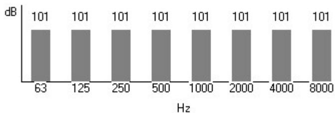
Dai dati misurati si sono inoltre stimati i seguenti valori di potenza acustica per il camino di aspirazione (ventilatore esterno a terra e terminale d'uscita)
