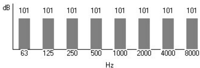
Dai dati misurati si sono inoltre stimati i seguenti valori di potenza acustica per il camino di aspirazione (ventilatore esterno a terra e terminale d'uscita)
