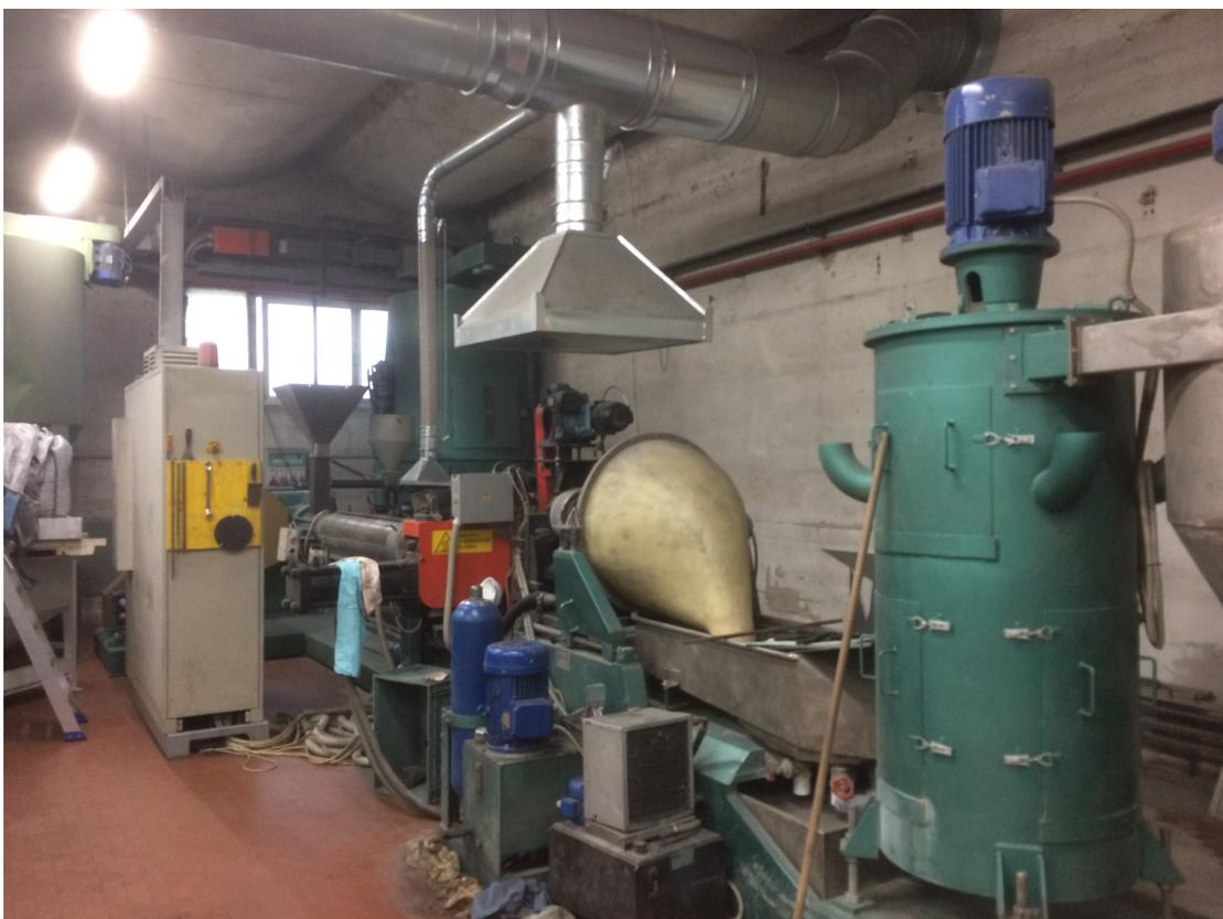
Foto 5. Uno degli estrusoti di progetto (non ancora in funzione)
