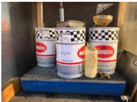
Il bacino di contenimento Modello ATEX-RL 94/9 EG prodotto dalla ditta DENIOS AG alla base del deposito olio motore e olio esausto entro box dedicato.
