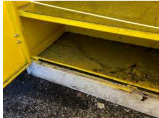
Particolare della vasca interna di raccolta a tenuta stagna sul fondo dell'armadio per liquidi infiammabili che stocca le taniche del carburante per go-kart.
