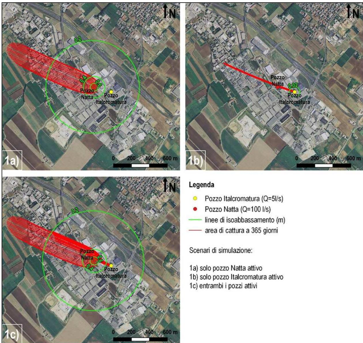
Figura 9: Confronto scenari di simulazione per analisi interferenza
