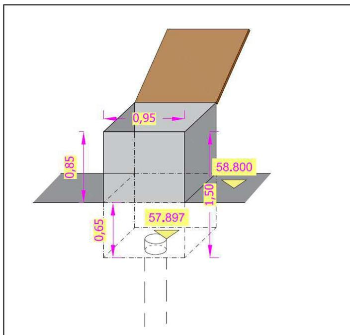
**Figura 2: Sezione pozzettone contenente la testa pozzo**
