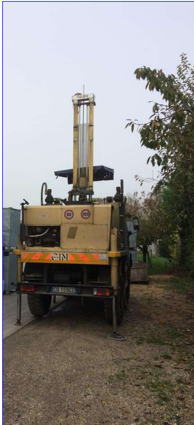
Caratteristiche Strumentali PAGANI TG 63 (200 kN)
