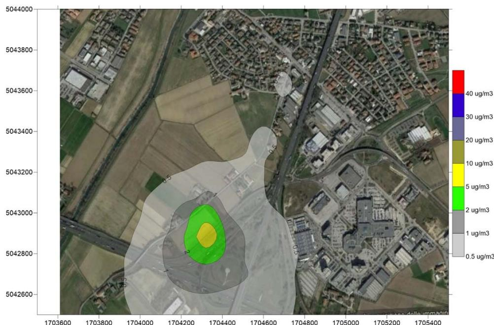
Figura 70: Applicazione del modello di dispersione, scenario impatti indotti. Inquinante NO<sub>2</sub>, media aritmetica annua (limite di legge 40 µg/m<sup>3</sup>)
