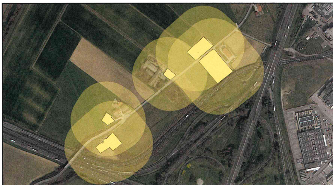
Figura 4: buffer di 100 m di distanza dalle civili abitazioni stabilmente occupate su base foto aeree
