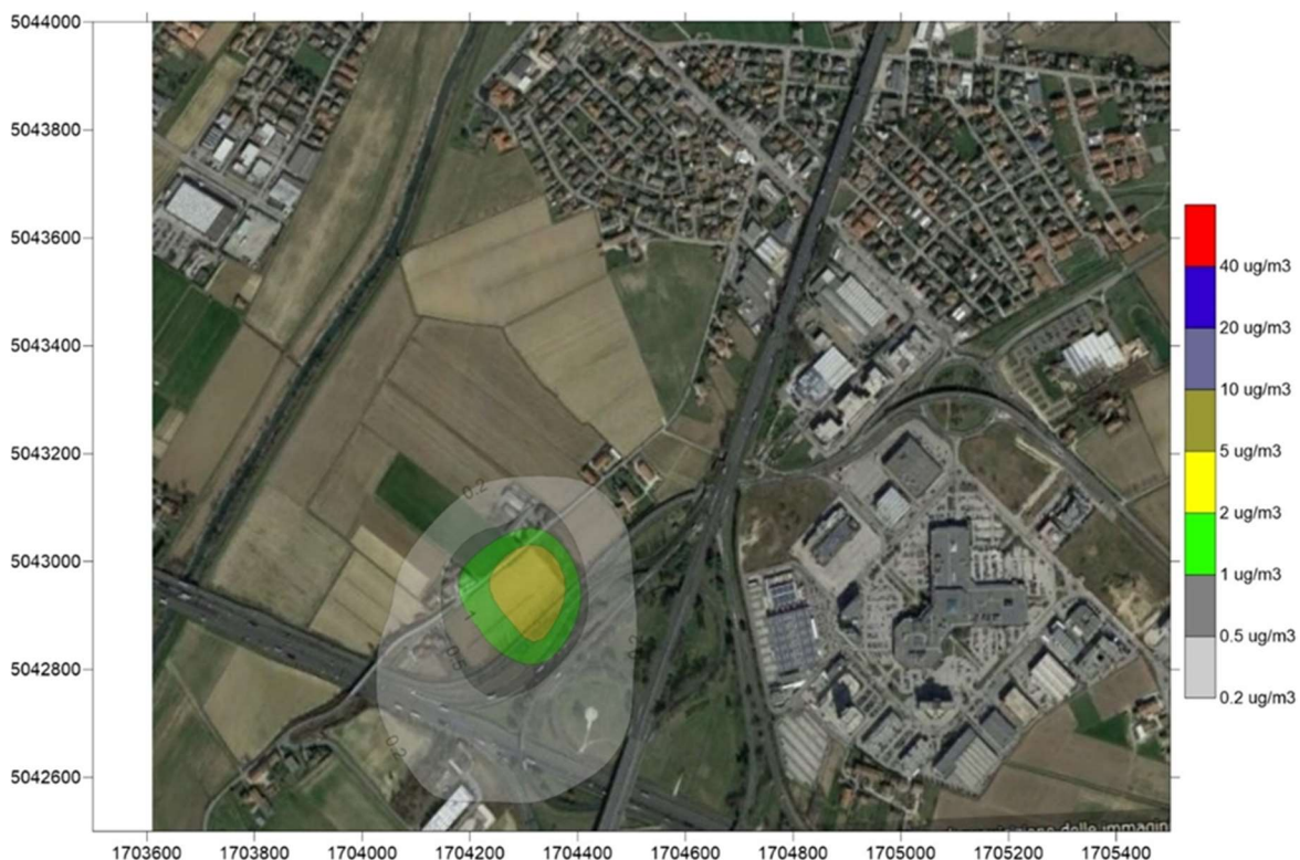
Figura 12: Applicazione del modello di dispersione, scenario impatti indotti. Inquinante PM10, media aritmetica annua (limite di legge 40 \mu\text{g}/\text{m}^3 )
