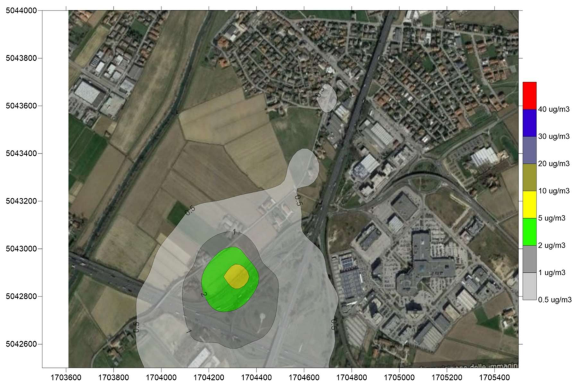
Figura 72: Applicazione del modello di dispersione, scenario impatti indotti. Inquinante \text{NO}_2 , media aritmetica annua (limite di legge 40 \mu\text{g}/\text{m}^3 )
