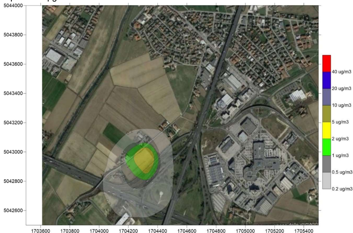
Figura 70: Applicazione del modello di dispersione, scenario impatti indotti. Inquinante PM10, media aritmetica annua (limite di legge 40 µg/m 3 )
