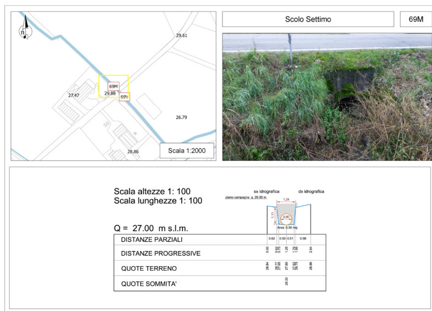
Fig. 6 – Estratto della Tav.11 del Piano delle Acque (aa.2018): esempio di interrimento di un tombotto situato a nord dell'area di intervento.
