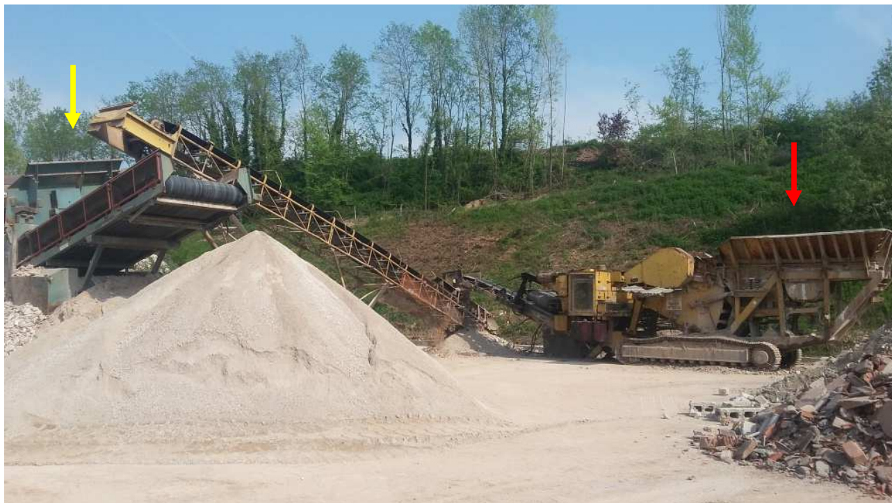
Figura 6 – Vista dell'area pavimentata "E" con accumulo del frantumato vagliato, del frantoio (freccia rossa) e del doppio vaglio (freccia gialla). Cono visuale CV_4
