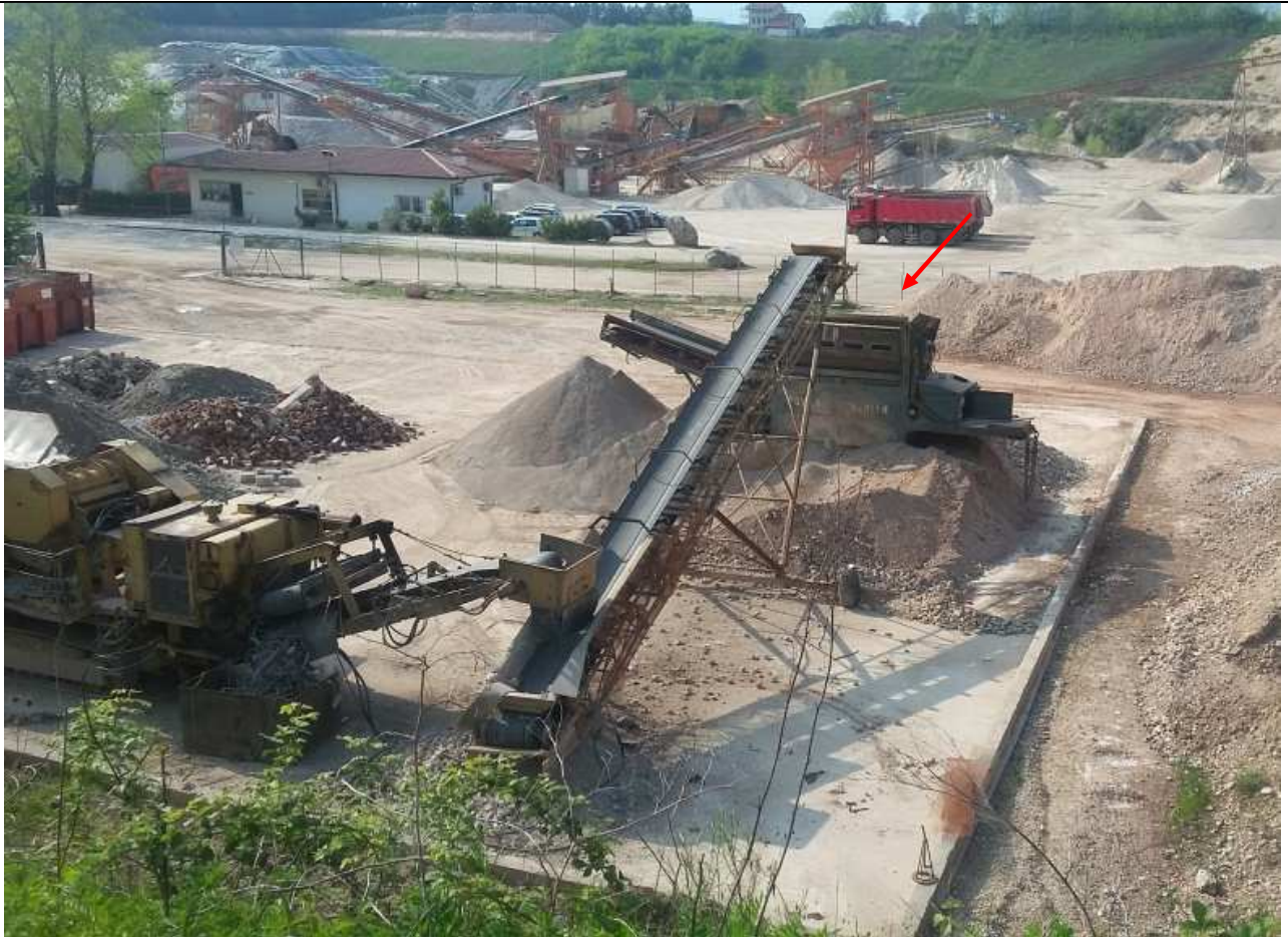
Figura 6 – Vista dall'alto del vaglio EXTEC (freccia rossa)
