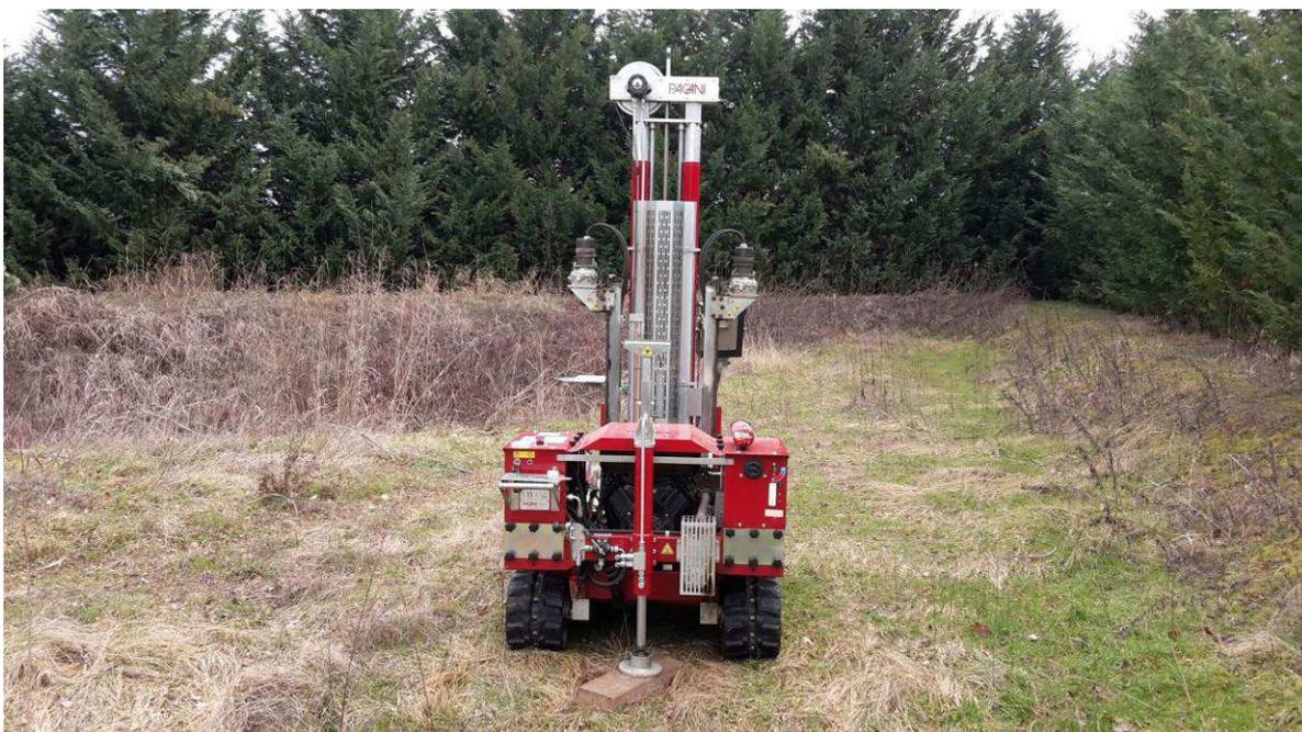
*Foto n°1: Realizzazione della di prova DPSH 1*
