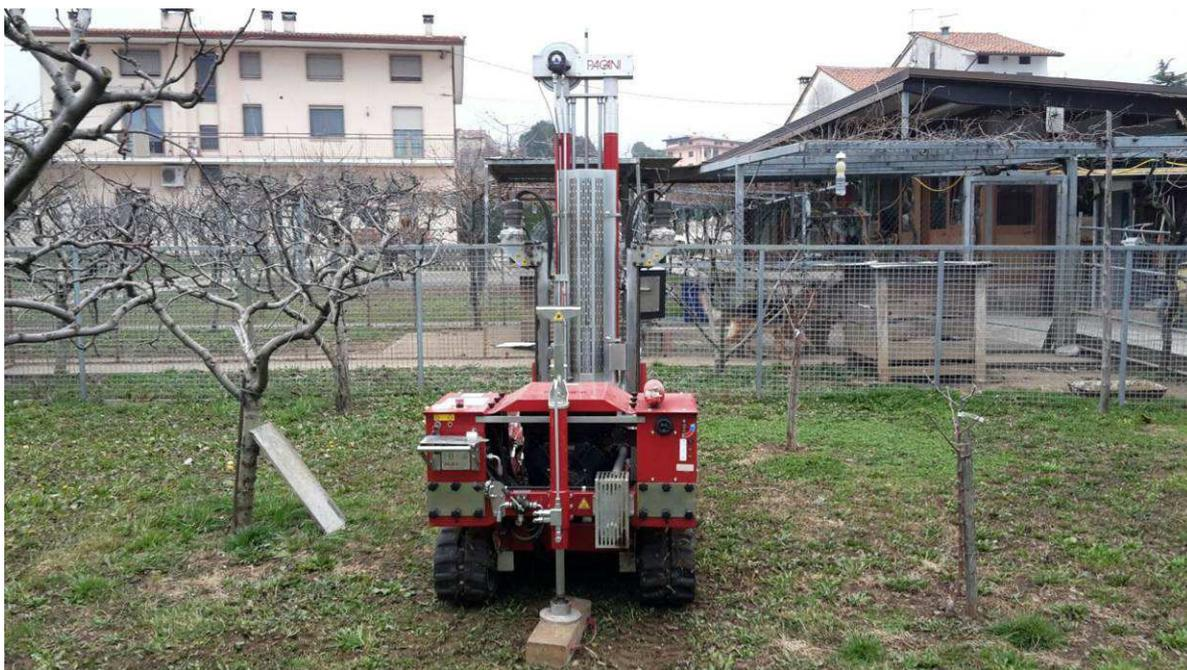
*Foto n°3: Realizzazione della prova DPSH 3*
