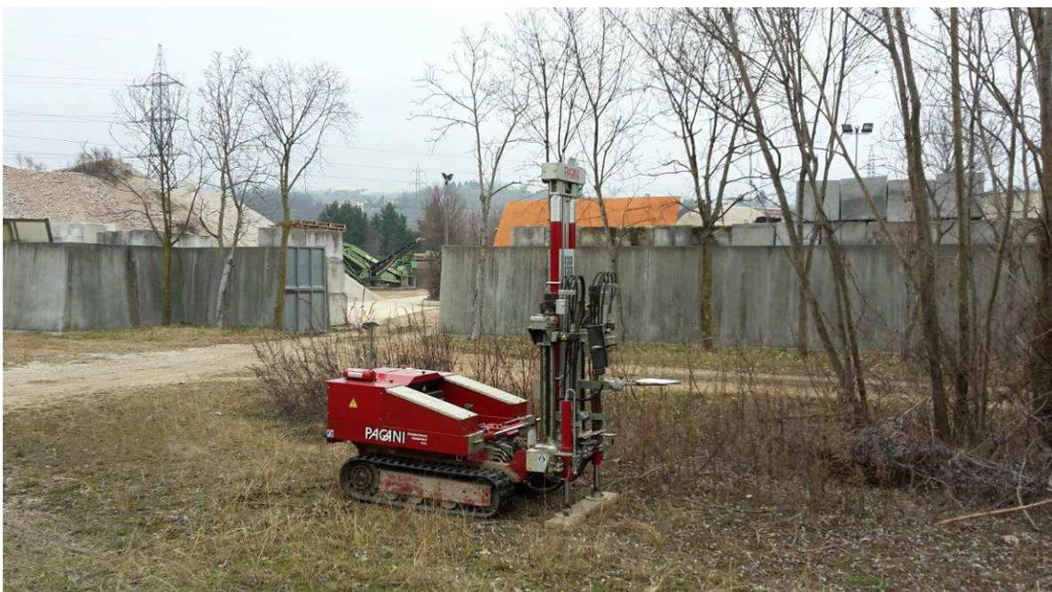
*Foto n°2: Realizzazione della prova DPSH 2*
