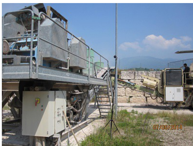
Granulatore Lp a 1,20 m= 93,4 dB(A)
