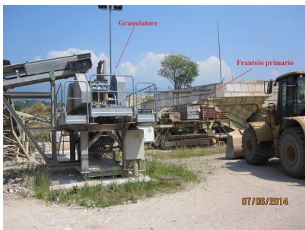
Frantoio primario Lp a 1,8 m= 99,3 dB(A)
