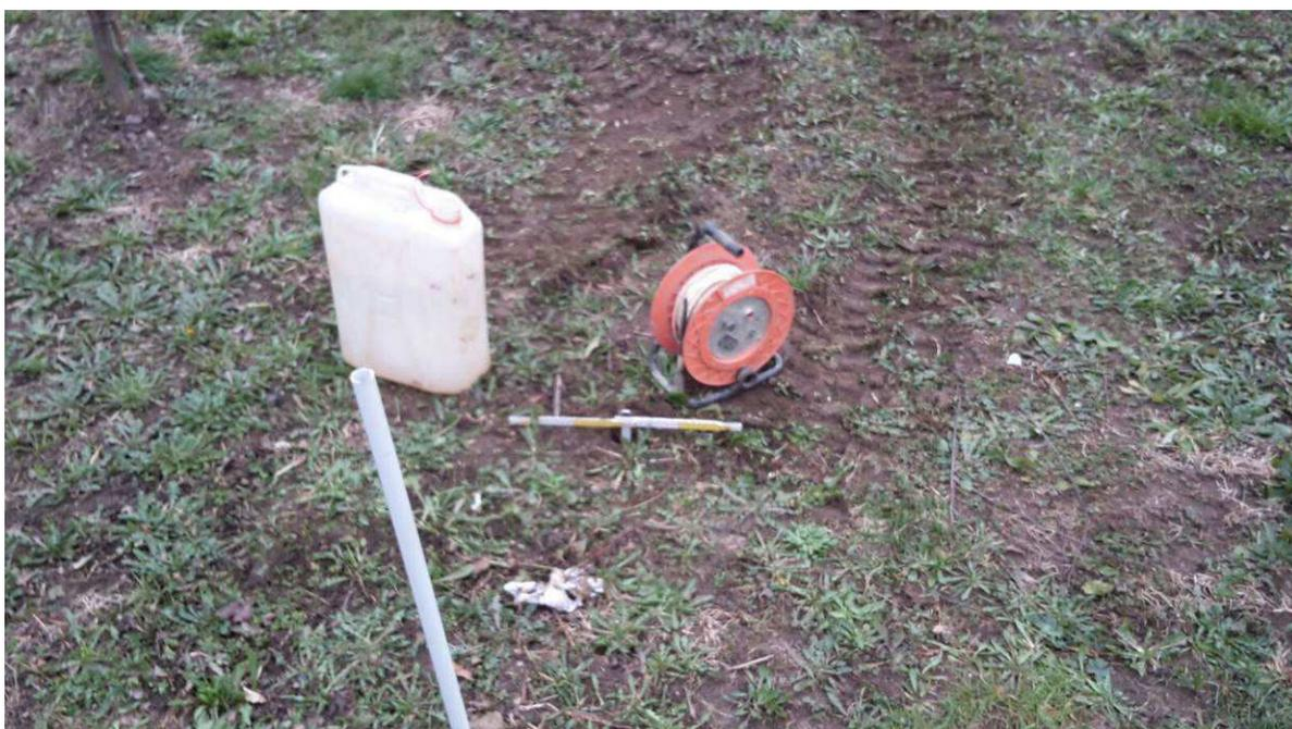
*Foto n°4 Prova di conducibilità idraulica K1*
