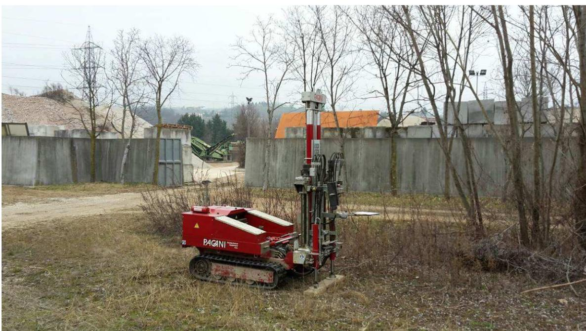
*Foto n°2: Realizzazione della prova DPSH 2*
