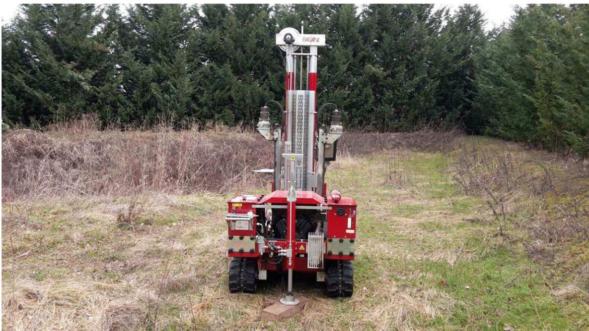
*Foto n°1: Realizzazione della di prova DPSH 1*
