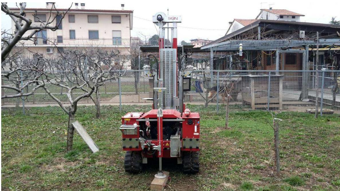
*Foto n°3: Realizzazione della prova DPSH 3*
