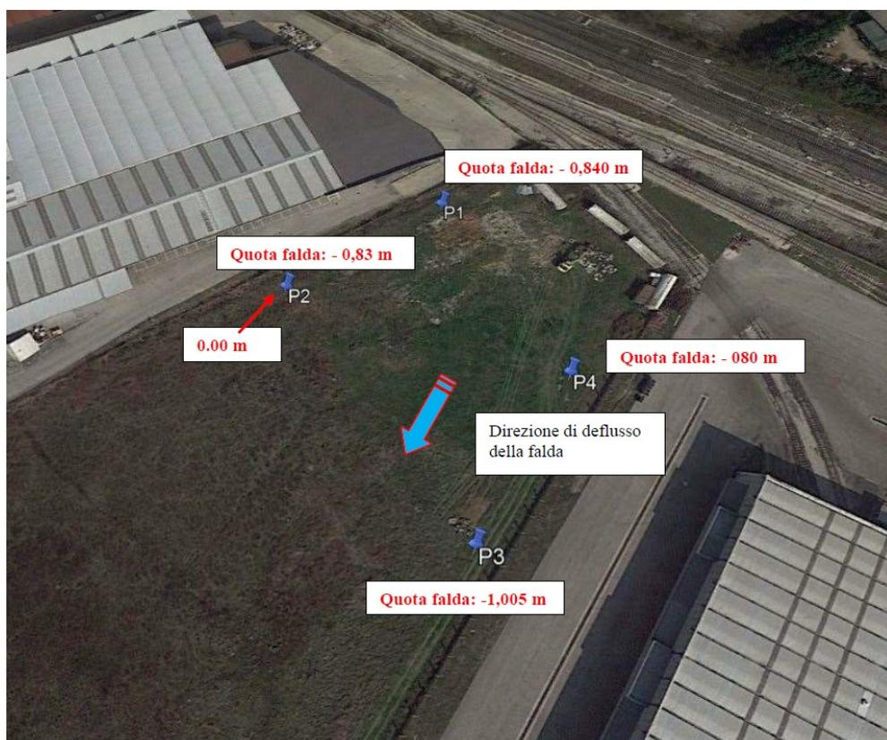
I piezometri sono stati quotati, con riferimento 0.00 m la testa del piezometro n° 2, ovvero quello posizionato a quota più bassa tra i 4 piezometri installati.
