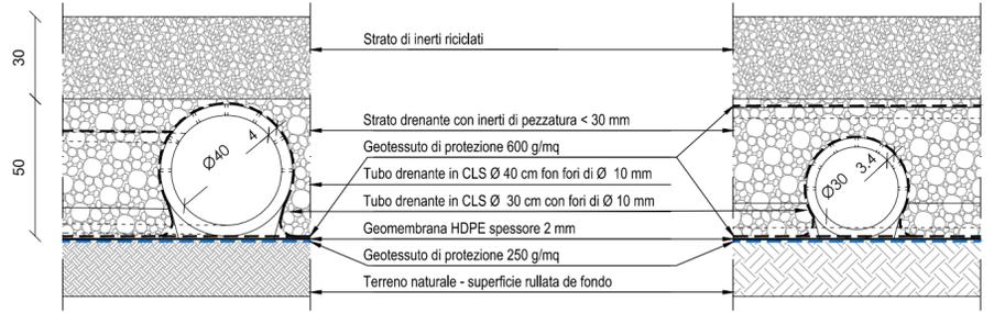
**PARTICOLARE COSTRUTTIVO PAVIMENTAZIONE IN ASFALTO PER VIABILITA' E PIAZZALE DI MANOVRA AUTOMEZZI**
