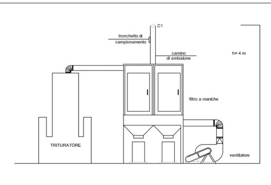
PARTICOLARE SISTEMA ABBATTIMENTO EMISSIONI IN ATMOSFERA
