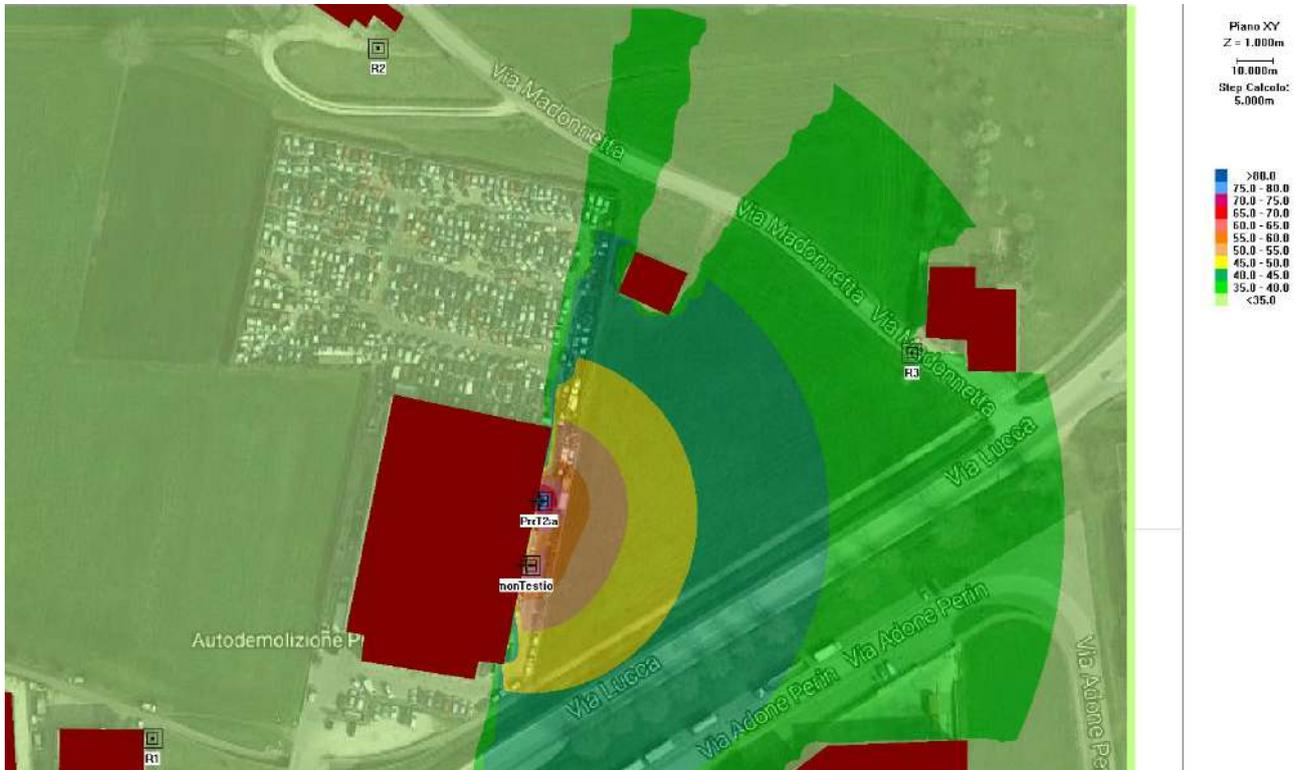
Ottenendo presso il ricettore R3 un valore futuro di emissione pari a 37,2 dB(A) dimostrando il rispetto di tale valore limite.
