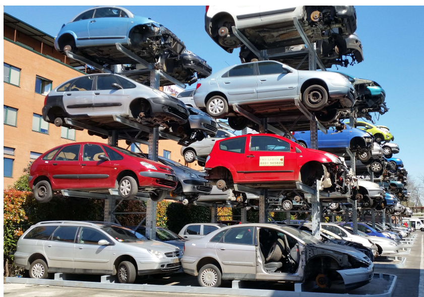
Figura 4 – Immagine esemplificativa della struttura "a cantilever"
