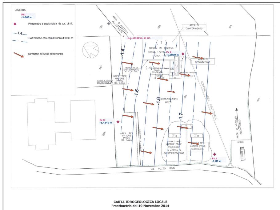
Sono state eseguite oltre alla misura della falda, anche prove di permeabilità sia in laboratorio ( sui campioni argillosi ) che in sito ( tipo Boutwell ) hanno dato come risultato una conducibilità idraulica variabile da  $1.01 \times 10^{-10}$  m/s a  $5.45 \times 10^{-11}$  m/s; pertanto, visti gli esiti delle prove di permeabilità in laboratorio e in sito, si evince per i terreni argillosi del Livello B ( secondo Casagrande-Fadum):
