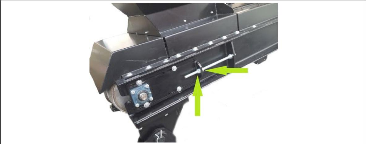
Agire sui due dadi M20 con la chiave da 30 per tensionare il tappeto del nastro. Agendo con uno dei due dadi si tensiona il tappeto mentre con l'altro si allenta; questo per poter allineare correttamente il tappeto rispetto ai tamburi.
