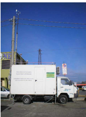
Stazione mobile ARPAV per i monitoraggi dell'aria nell'area della concia
