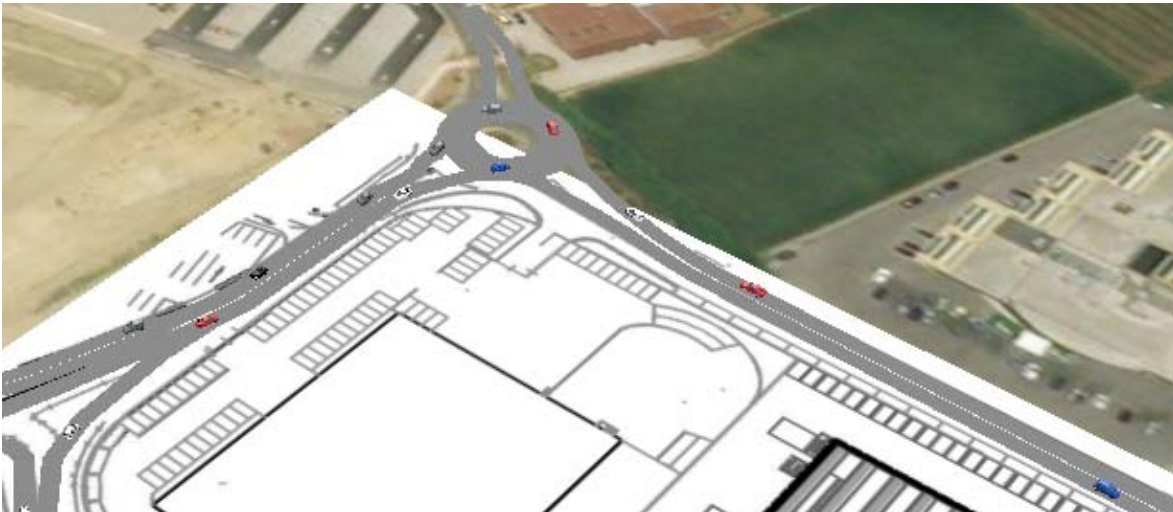
Figura 22 – microsimulazione intersezione 3, scenario di progetto
