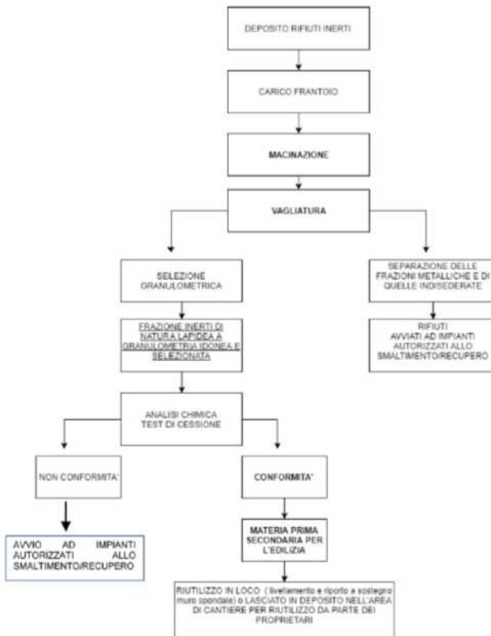
Figura 7 – Diagramma di flusso delle operazioni svolte
