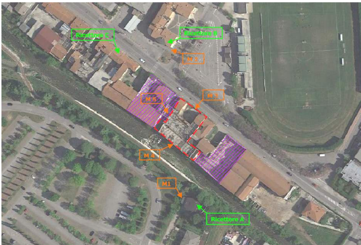
Fig. 11 - Corografia da foto satellitare del lotto interessato dall'intervento con indicati i punti di rilevamento acustico
