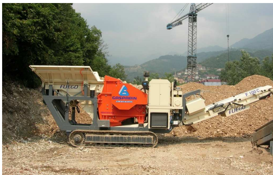
Figura 1 : vista del frantoio mobile di proprietà Furgoni srl
