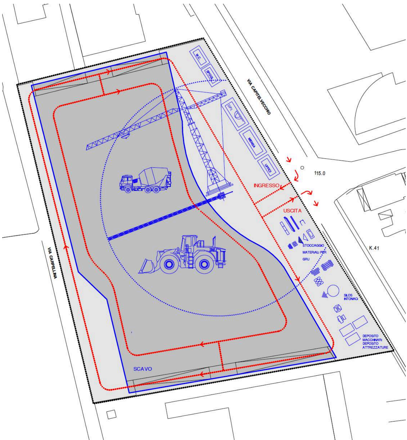
Figura 4 - Planimetria di cantiere
