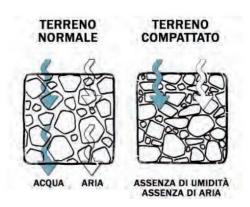
Figura 14 - Effetti negativi del compattamento del terreno
