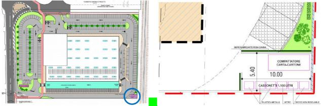
Planimetrie di progetto – Individuazione "isola ecologica" (a sn) e dettaglio della stessa (a dx)
