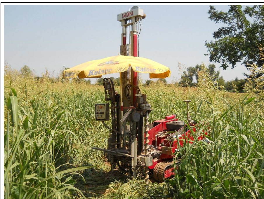
Foto 3: Esecuzione della prova DPSH3
