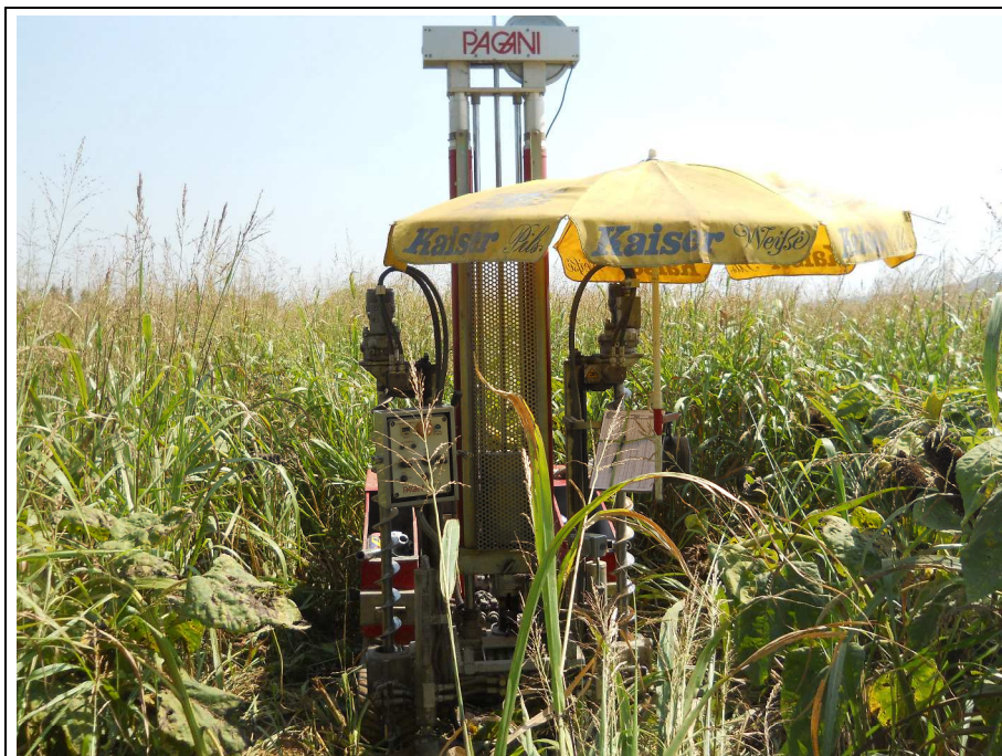
Foto 5: Esecuzione della prova DPSH5
