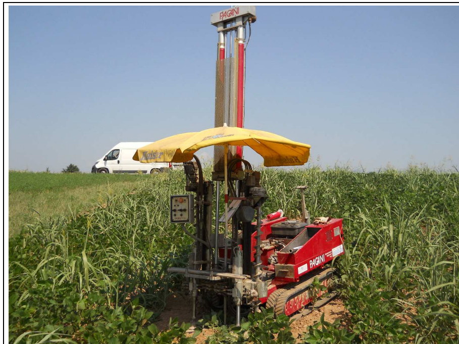
Foto 1: Esecuzione della prova DPSH1
