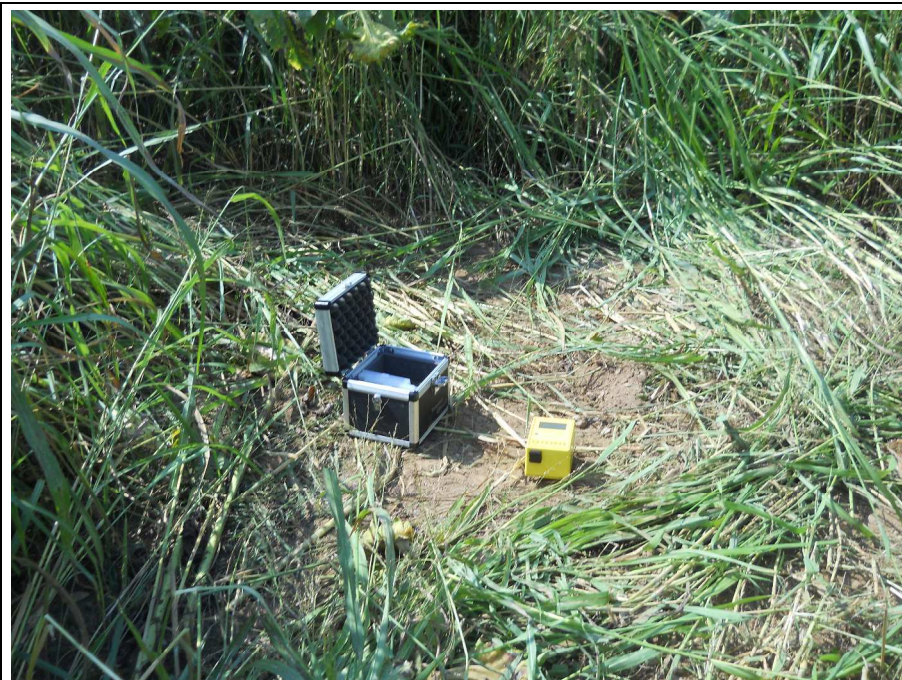
Foto 7: Esecuzione indagine sismica passiva
