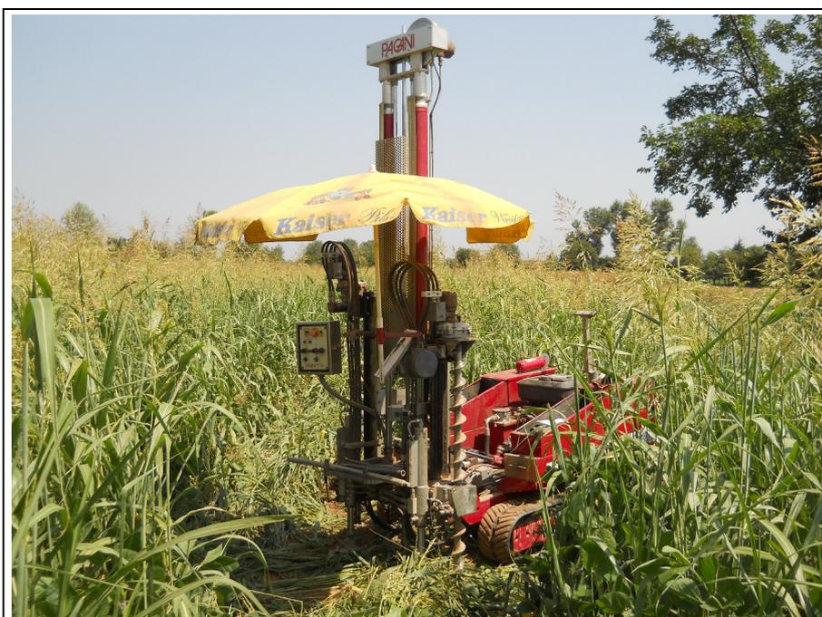
Foto 3: Esecuzione della prova DPSH3
