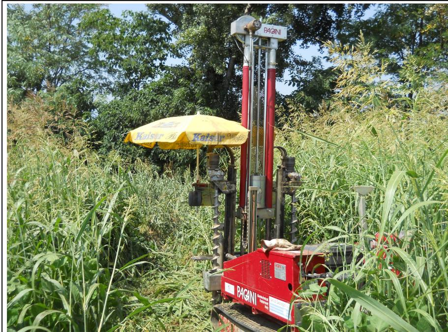
Foto 4: Esecuzione della prova DPSH4
