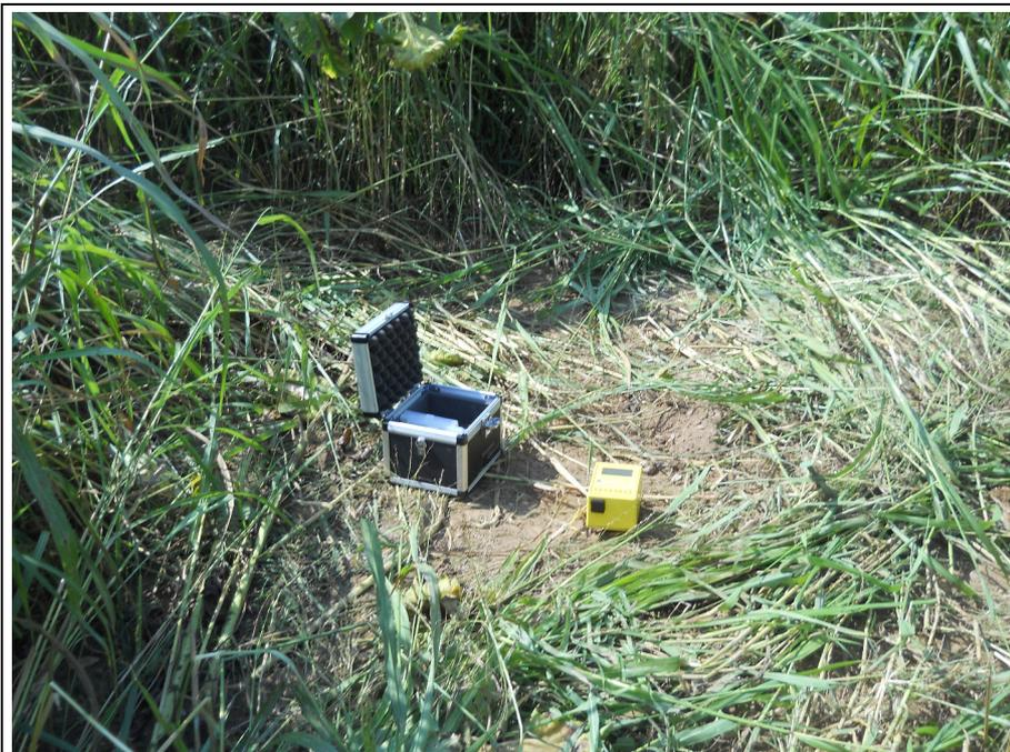
Foto 7: Esecuzione indagine sismica passiva
