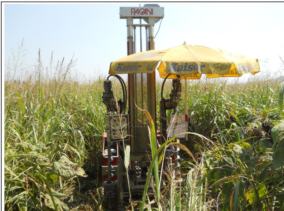
Foto 5: Esecuzione della prova DPSH5
