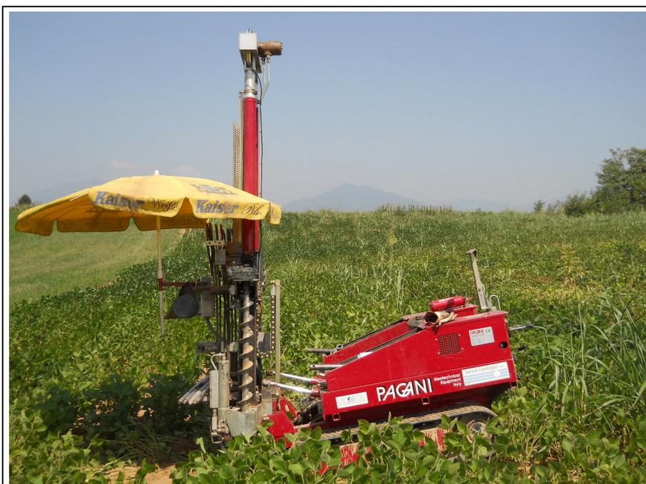
Foto 2: Esecuzione della prova DPSH2
