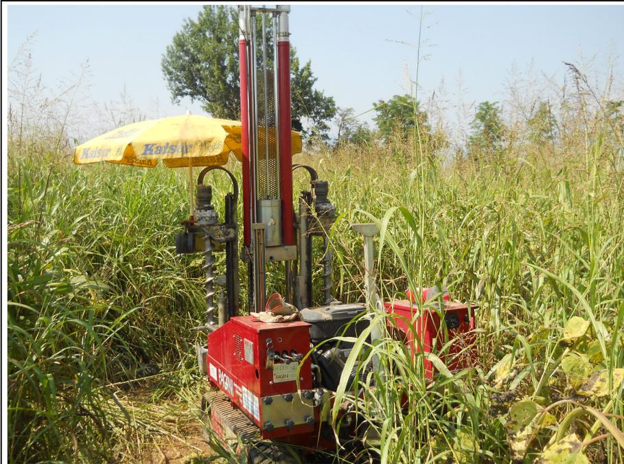
Foto 6: Esecuzione della prova DPSH6
