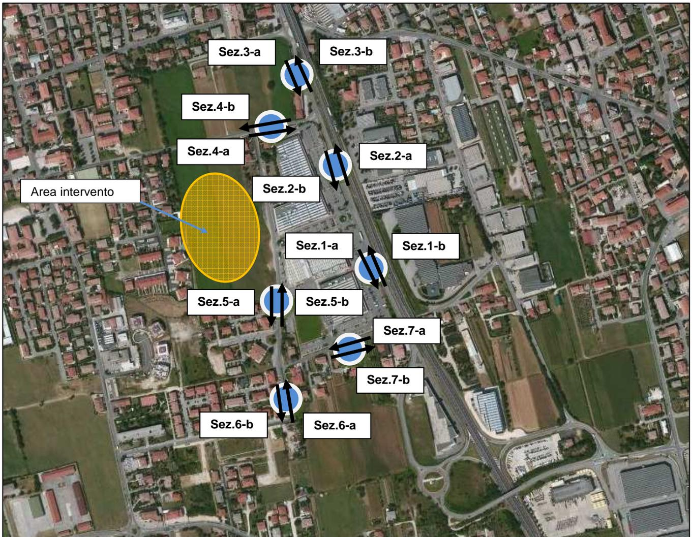
Immagine 4: Localizzazione sezioni di rilievo flussi veicolari
