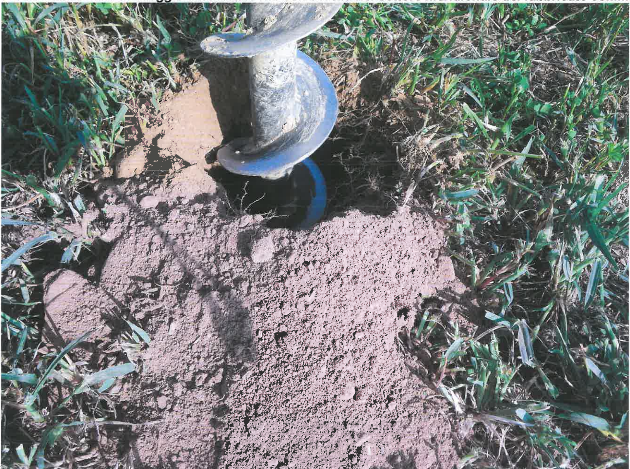
Foto n 8 : Prelievo del campione di terreno nel Sondaggio ambientale N.4 spinto alla profondità di -100cm.
