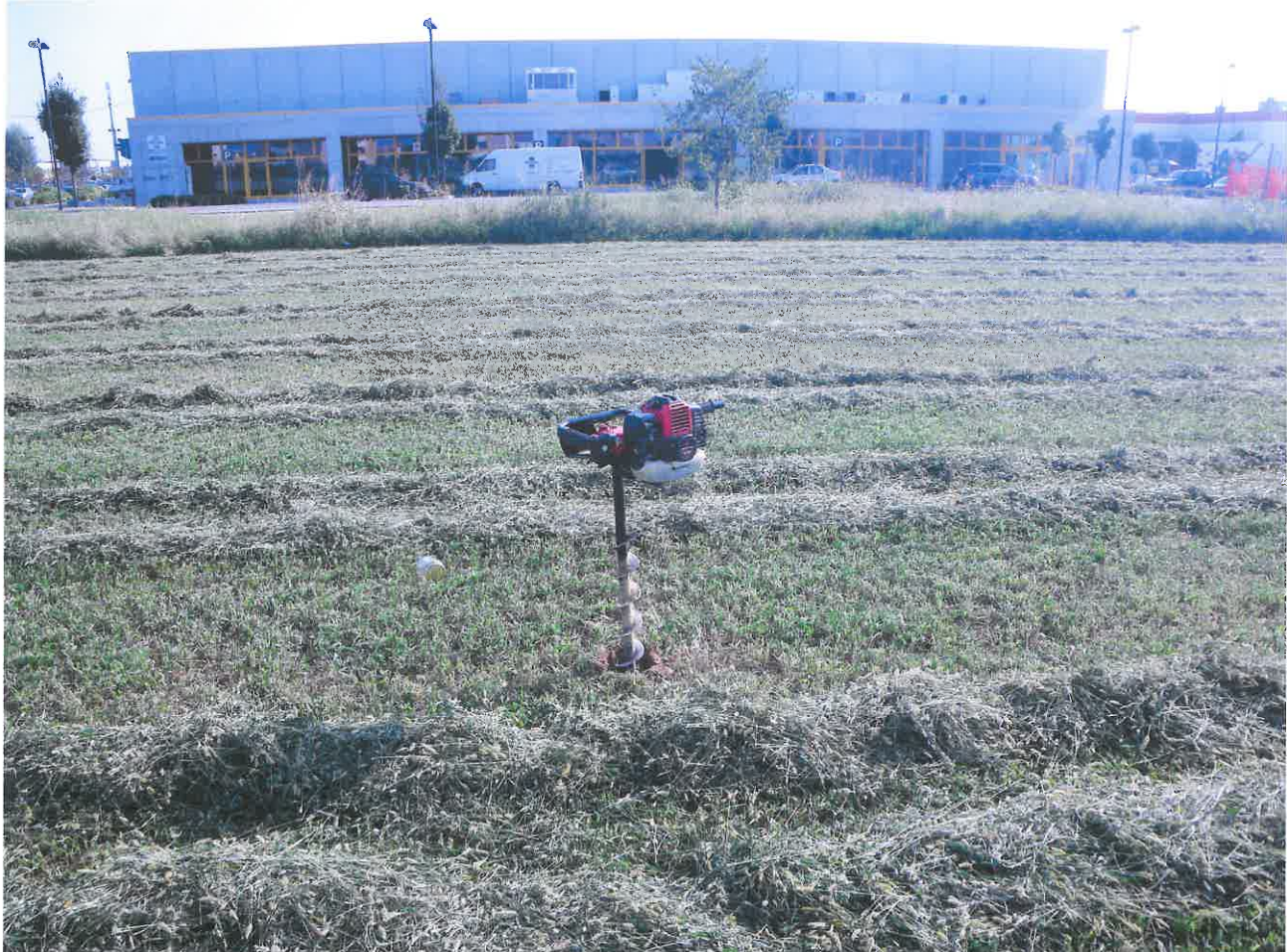
Foto N.7 : Esecuzione del Sondaggio ambientale N.4 con trivella nel settore meridionale del fabbricato commerciale
