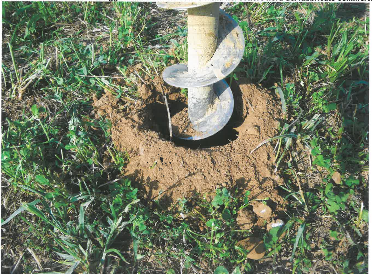
Foto n 4 : Prelievo del campione di terreno nel Sondaggio ambientale N.2 spinto alla profondità di -100cm.
