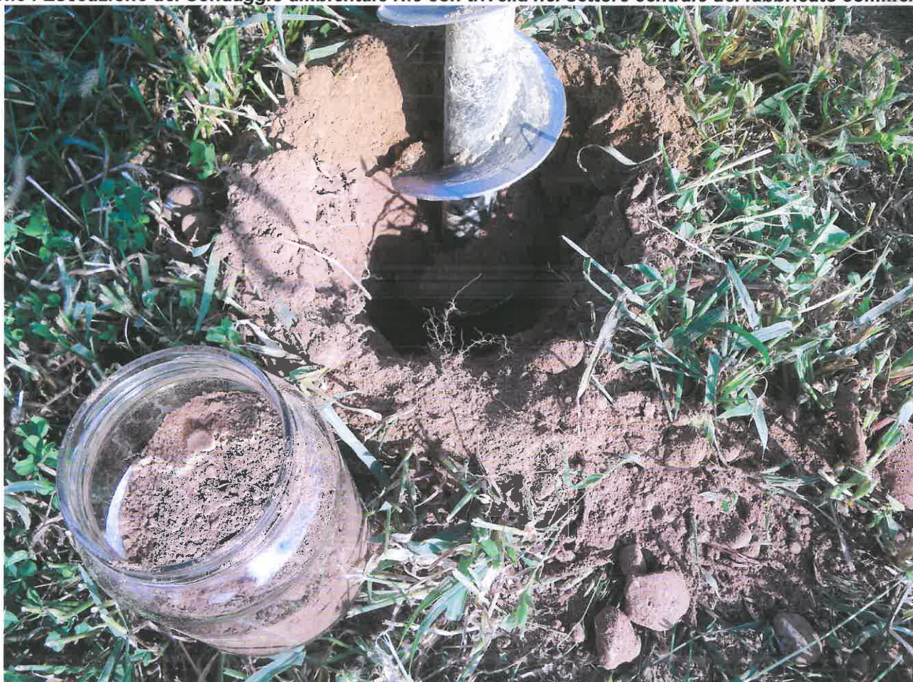
Foto n 6 : Prelievo del campione di terreno nel Sondaggio ambientale N.3 spinto alla profondità di -100cm. Rilievo fotografico : 04 Ottobre 2011
