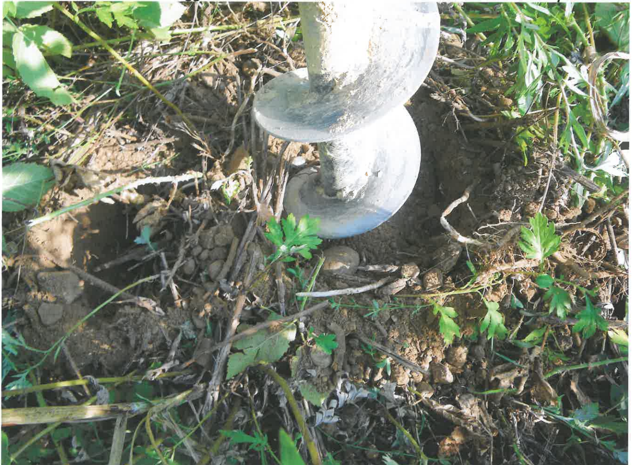
Foto n 2 : Prelievo del campione di terreno nel Sondaggio ambientale N.1 spinto alla profondità di -100cm. Rilievo fotografico : 04 Ottobre 2011
