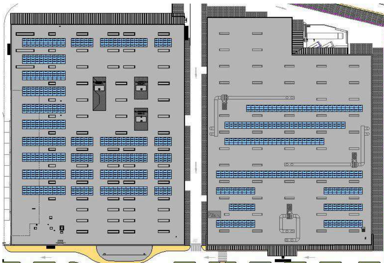
Figura 5.4 – Estratto coperture con impianti fotovoltaici
