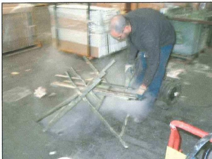
Carotaggio S2 - Operazioni di pulizia delle aste con vapore per evitare fenomeni di contaminazione incrociata
