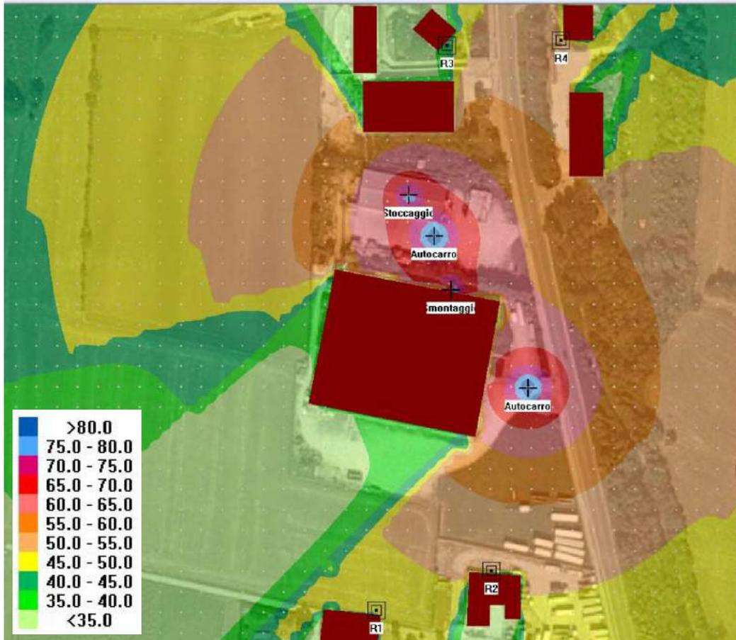
Per la verifica del rispetto dei limiti, nel documento di previsione di impatto acustico, si è fatto riferimento, cautelativamente, ad un tempo di funzionamento simultaneo degli impianti (smontaggio, stoccaggio, movimentazione materiale tramite carrello elevatore e transito di autocarri nell' area aziendale) pari a 10 ore nel periodo di riferimento diurno.
