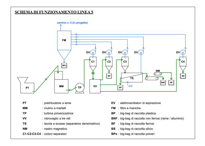
La configurazione impiantistica è pertanto tale da giustificare la presenza del filtro a maniche, in pratica soltanto per la rimozione di un esiguo (residuo) carico di polveri, con risultati ottimali, come è del resto confermato dagli esiti dei controlli analitici effettuati.
