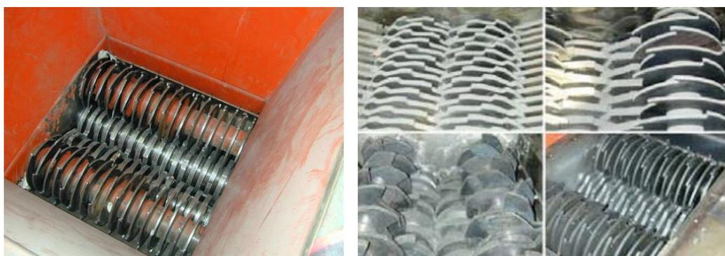
La produzione di materiale truciolato varia in relazione alla tipologia dei pezzi da triturare ed alla pezzatura che si vuole ottenere. E' dotato di un sistema di sicurezza di inversione e rotazione in caso di sovraccarico. E' una macchina versatile, adatta ai diversi tipi di scarti, è a basso consumo di energia e bassa rumorosità; quindi particolarmente adatte alle piccole e medie imprese.
