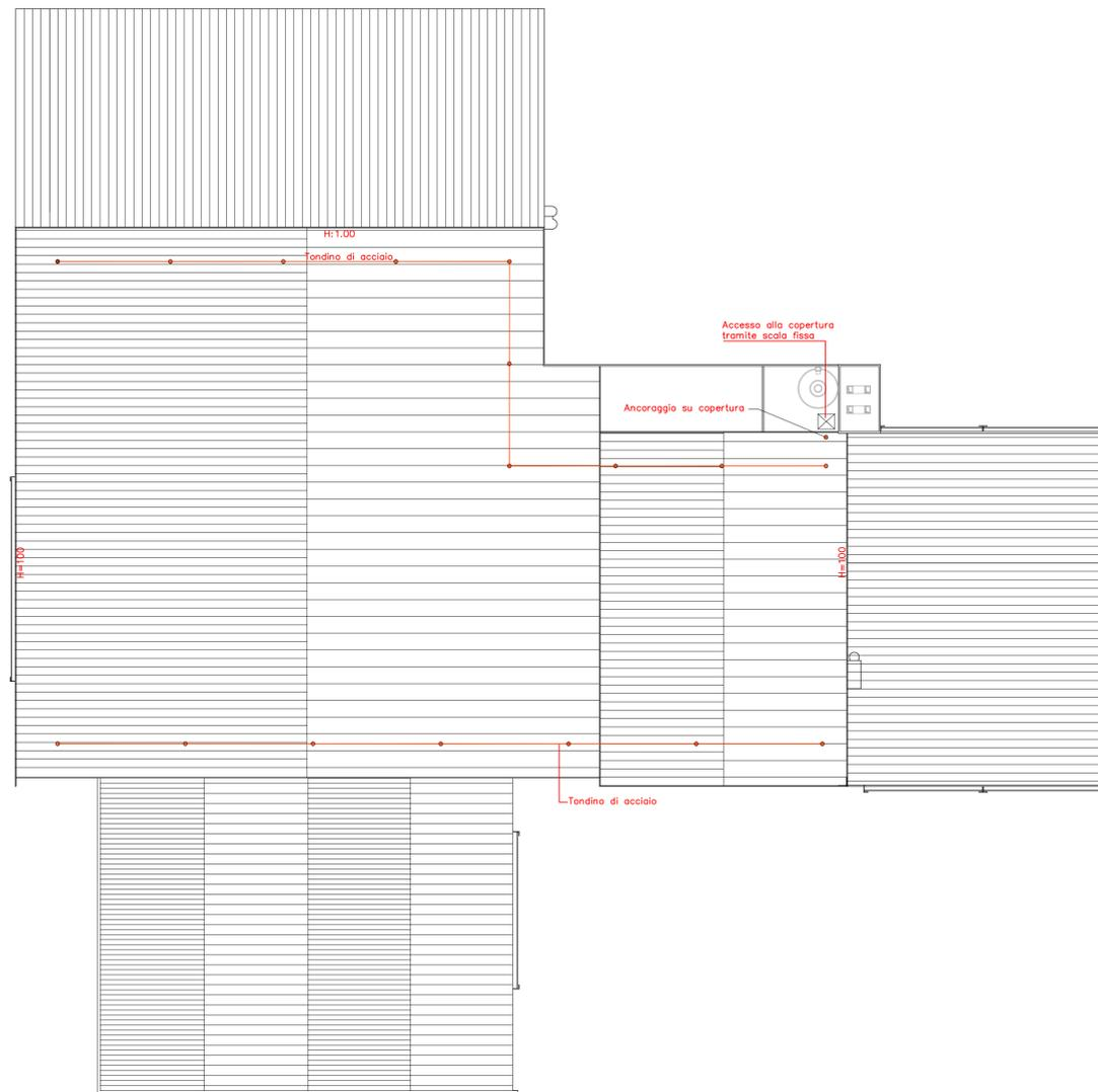
PIANTA COPERTURA - LINEE VITA TETTO ALTO
