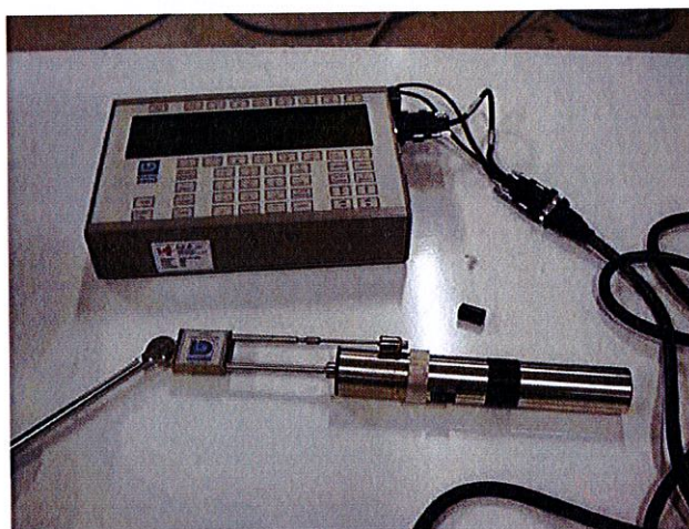
Esempio di calibrazione della sonda intensimetrica in pressione
