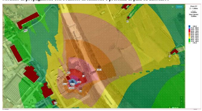
Modello di propagazione con Frantoio in funzione e presenza di pala ed autocarro
