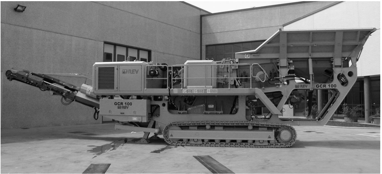
Figura 5. Frantoio semovente REV-GCR 100_P02 Matricola 10998.
